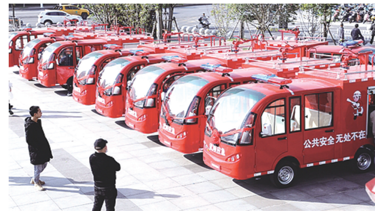
11月9日,湖南常德市武陵区在119消防宣传月启动仪式上将10辆“迷你”电动消防车发放至街道使用。该消防车配备有消防机动泵、水枪、水带、消防斧、消防栓扳手等器材,解决了老旧小区消防通道狭窄,大型消防救援车辆难以通过的问题。陈自德摄
