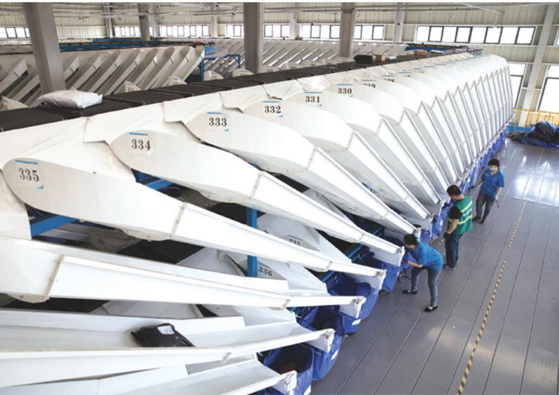
11月18日,工作人员在一家物流公司无锡分拨中心,利用交叉带自动分拣系统分拣包裹。据介绍,该系统是现代物流体系中的核心智能装备,能够高效率、低误差地实现物流快速自动分拣。这项系统的研发主体——中科微至由中科院微电子所孵化。在中科院科技成果转化项目“弘光专项”支持下,目前已完成大件包裹自动分拣系统、经济型动态称系统等研制,并在快递、电商领域得到运用。新华社记者 金立旺 摄
