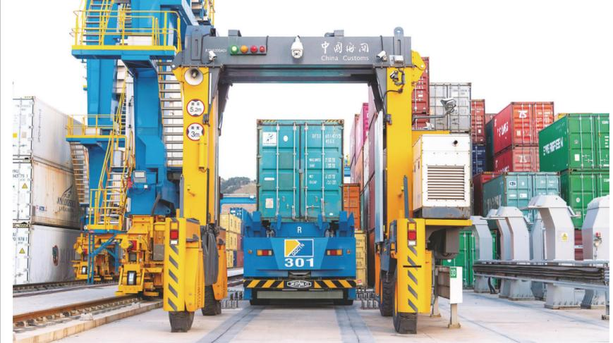
青岛海关推广先期机检新模式,进口货物有机检查验要求的,卸船后顺势经过码头前沿的先期机检设备进行非侵入式筛查。图为青岛海关设置在青岛港全自动化集装箱码头的先期机检设备。 毕顺 摄
