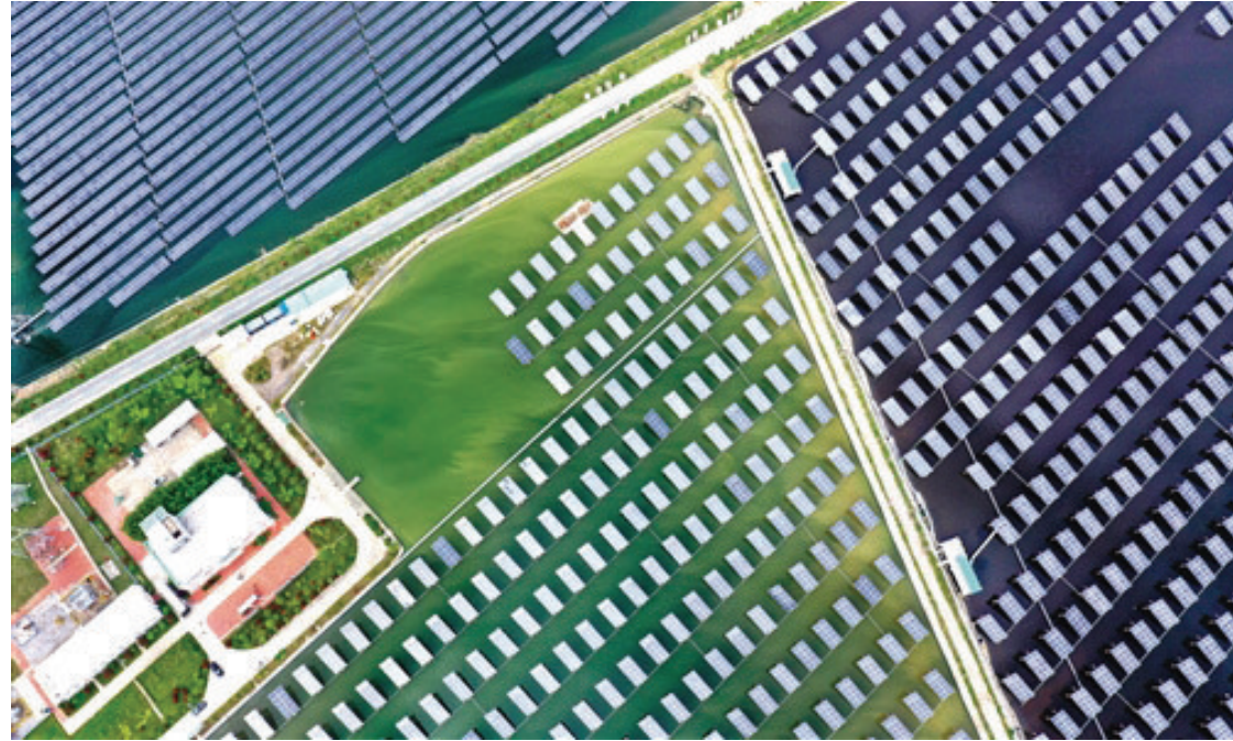
↑5月12日拍摄的江苏盐城东台沿海“风光渔”互补产业基地。该基地按照集约集聚的开发理念,形成“上有风力发电、中有光伏利用、下有水面养殖”的“风光渔”互补立体开发模式,建成了国内最大的“风光渔”一体化电站,实现滩涂资源高效利用效益最大化,国能、中节能、华电等一批央企国企投资落户。目前,基地新能源装机容量突破1.5GW。肖勇 摄(中经视觉)
