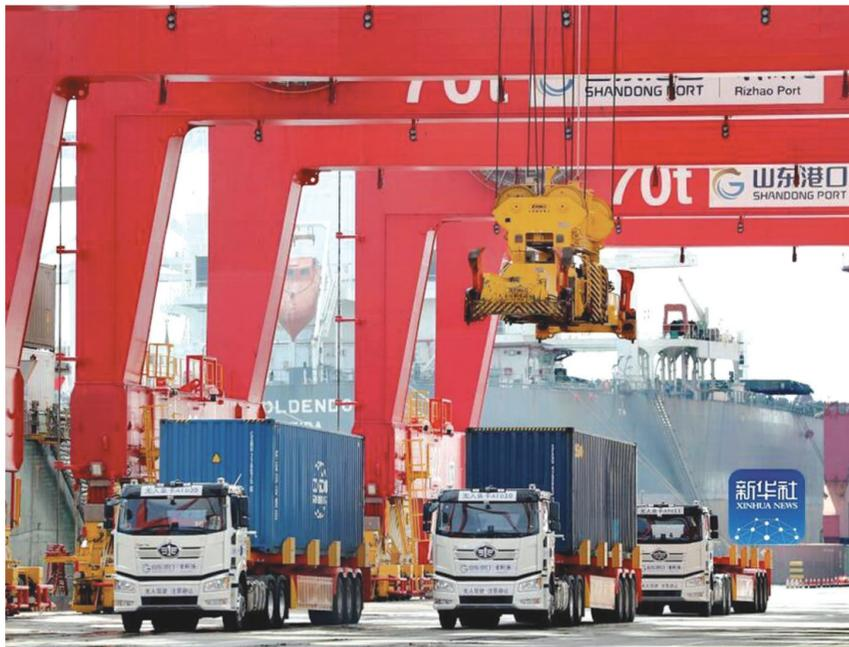
10月9日,在山东港口集团日照顺岸开放式全自动化集装箱码头,无人集卡车在运送集装箱。当日,顺岸开放式全自动化集装箱码头在山东港口集团日照港建成启用。日照港将传统码头改造升级为全自动化集装箱码头,实现了自动化轨道吊“少跑路”,集卡车在堆场“自由行”,降低综合能耗和成本。新华社发(张进刚 摄)
