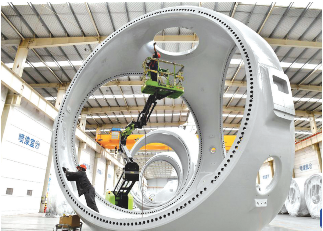
在山东省惠民县风电装备制造产业基地涂装车间，工作人员对风电轮毂进行涂装。山东省惠民县近年来以新能源产业为抓手助推县域经济高质量发展，依托原有风电产业基础，引入国内风电行业龙头企业，着力打造大功率风电装备制造产业基地。目前惠民县已形成风电设备设计、铸造、加工、涂装、运输于一体的全链条风电产业集群。新华社记者 郭绪雷 摄
