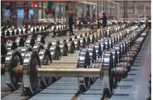
3月27日，在哈尔滨车辆段生产车间，工作人员运输已经修复好的车轮。当前，正值春耕大省黑龙江备春耕阶段，化肥、农药等农用物资运输进入高峰期。为全力保障春耕重点物资运输效率，中国铁路哈尔滨局集团有限公司加大科技应用，提升货运列车车轮检修速度和上线率，为货车上线提质增效。
