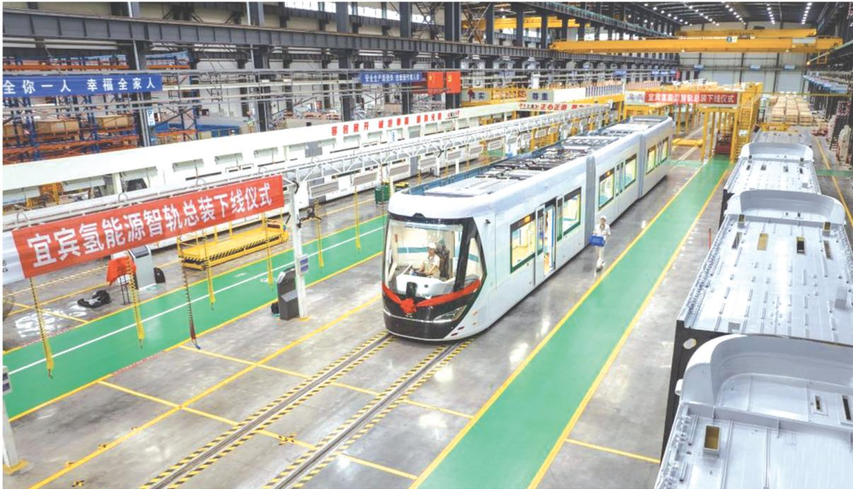
7月1日,在位于四川省宜宾的中车铁投轨道交通产业基地生产车间,氢能智轨电车总装下线。该氢能智轨电车由我国自主研发,将于今年8月在宜宾智轨T4线投入使用。
